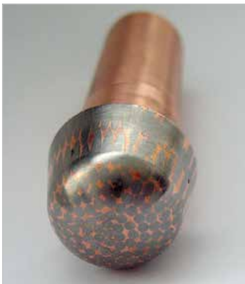
Štruktúra elektródy z W-Cu kompozitu na vedenie tepla s vysokoteplotnou odolnosťou.
